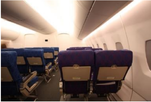
Abbildung 51: „Chronobiologische“ LED-Beleuchtung im Airbus-Kabinenmodell: „Warmweißes“ Licht zu Beginn eines simulierten Nachtflugs ...“.
