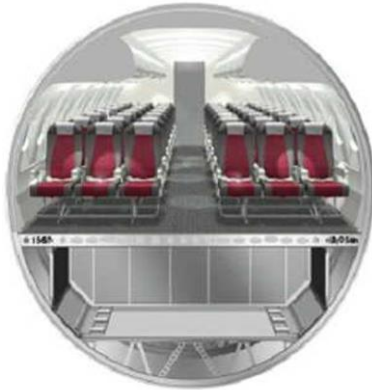
Abbildung 33: Querschnitt Kabine und Gepäckraum.
