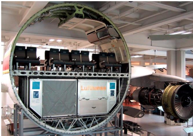
Abbildung 45: Schnitt durch den Flugzeugrumpf eines Airbus A-300 mit Unterflur-Frachtraum.
