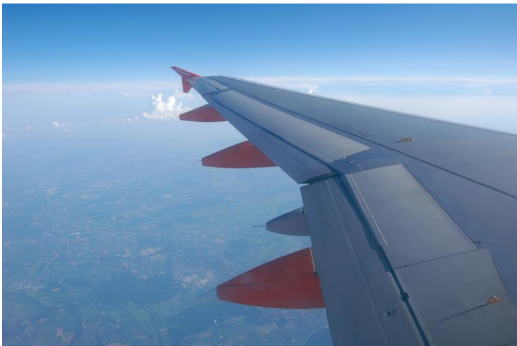
Abbildung 25: Tragwerk mit Winglet am Ende der Tragfläche.
